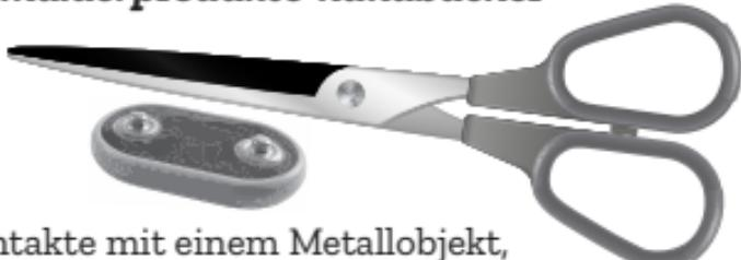
Sensorkontakte mit einem Metallobjekt, z. B. einer Schere, überbrücken.
