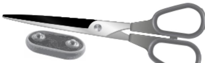
Court-circuitez les contacts sur le capteur à l'aide d'un objet métallique tel qu'une paire de ciseaux.
